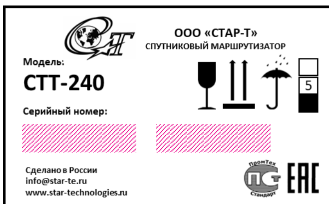
Рисунок 4. Этикетка маркировки упаковки спутникового маршрутизатора
